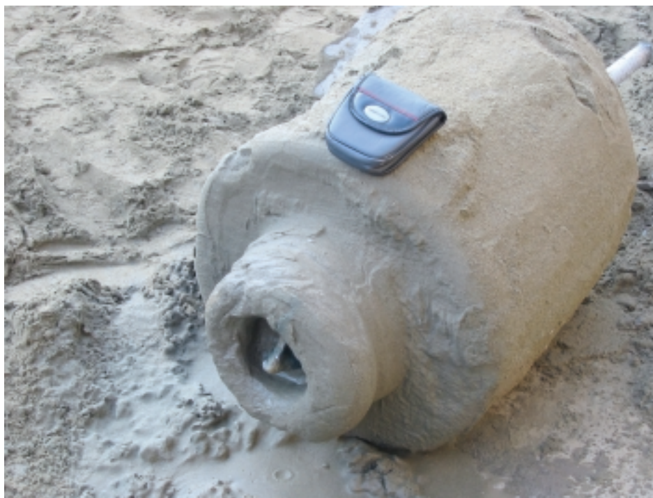
Fig. 27 - Bulbo d'ancoraggio "MINIJET" / "MINIJET" bond zone
