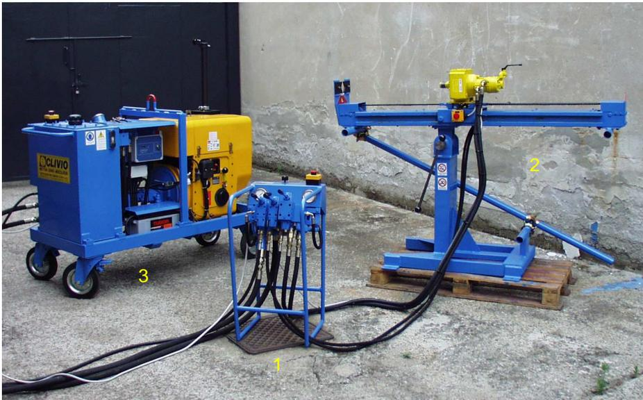
La sonda perforatrice **CLIVIO** mod. MINIRAP-X è una macchina idraulica adatta all'esecuzione di fori di piccoli diametro, preferibilmente non superiore a 100 mm., e di lunghezza limitata, sia a carotaggio che a distruzione e per lo più in muratura o in materiale compatto. Per renderla più maneggevole e facilitarne l'impiego in spazi ridotti, la MINIRAP-X viene costruita in tre parti separate:
