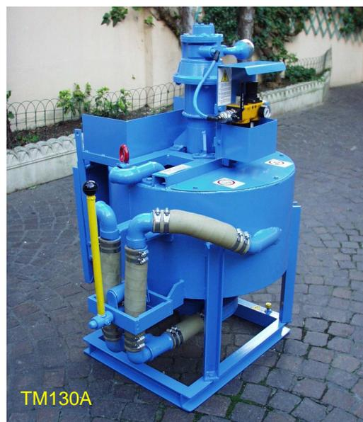
I Turbomescolatori CLIVIO mod. TM sono stati appositamente studiati per ottenere un alto grado di mescolazione delle miscele da iniettare. L'azione "laminante" della speciale girante e la possibilità di riciclare la miscela con alta turbolenza facilitano un impasto omogeneo dei componenti e ne creano una miscela di iniezione ad alto rendimento.
