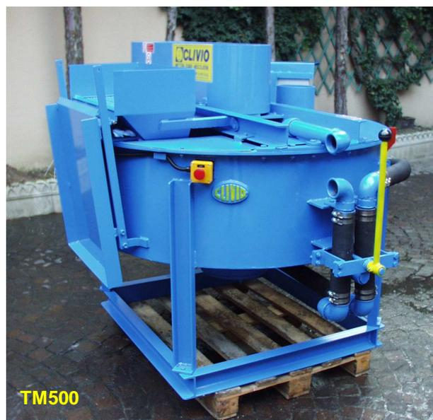
I Turbomescolatori CLIVIO mod. TM sono stati appositamente studiati per ottenere un alto grado di mescolazione delle miscele da iniettare. L'azione "laminante" della speciale girante e la possibilità di riciclare la miscela con alta turbolenza facilitano un impasto omogeneo dei componenti e ne creano una miscela di iniezione ad alto rendimento.
