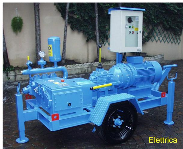
La pompa triplex mod. T202 è del tipo a pistoni tuffanti con premistoppa e lavaggio continuo dei pistoni, pertanto è valida per pompare liquidi di varie densità e natura. Semplicità, robustezza e qualità garantiscono la massima affidabilità. Caratteristiche peculiari: ingranaggi e alberi in acciaio trattato ad alta resistenza – pistoni in acciaio con cromatura a spessore – corpo pompa in ghisa speciale – valvole sferiche – speciali guarnizioni di tenuta pistone/premistoppa.
